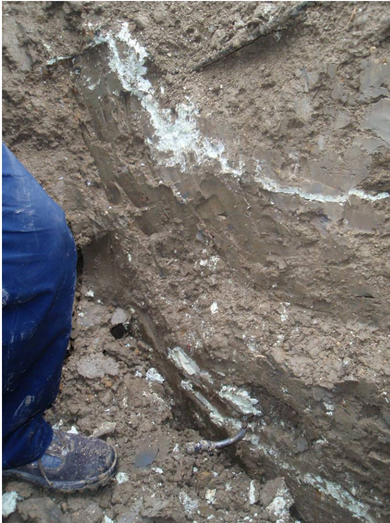
Figura 14, expansión del material de inyección en el tegel
