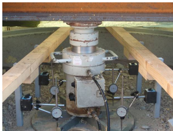
Figura 4, Cilindro hidráulico y placa de carga con dispositivos comparadores
