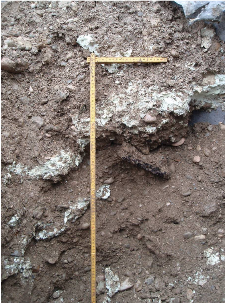
Figura 9, expansión de la resina en la grava
