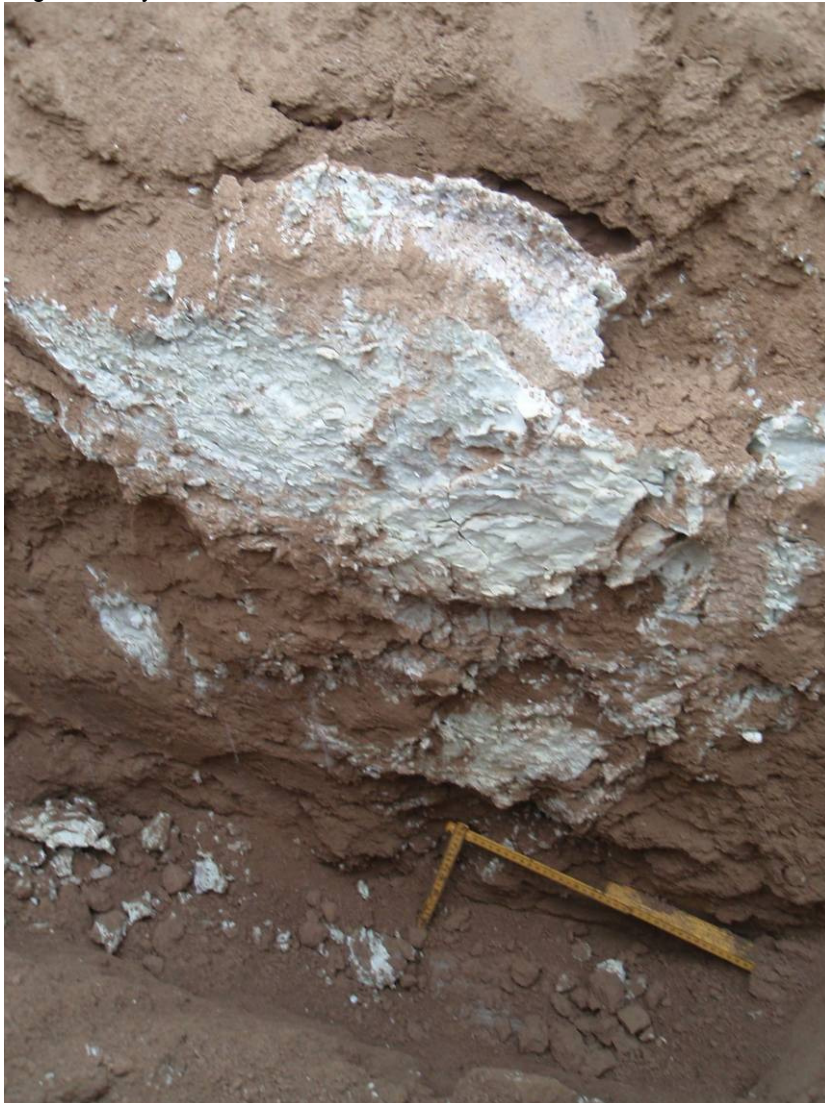
Figura 17, expansión de la resina en el área circostante el punto de inyección
