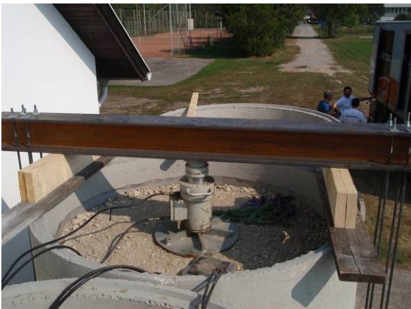
Figura 3, Placa de carga con elementos portantes
