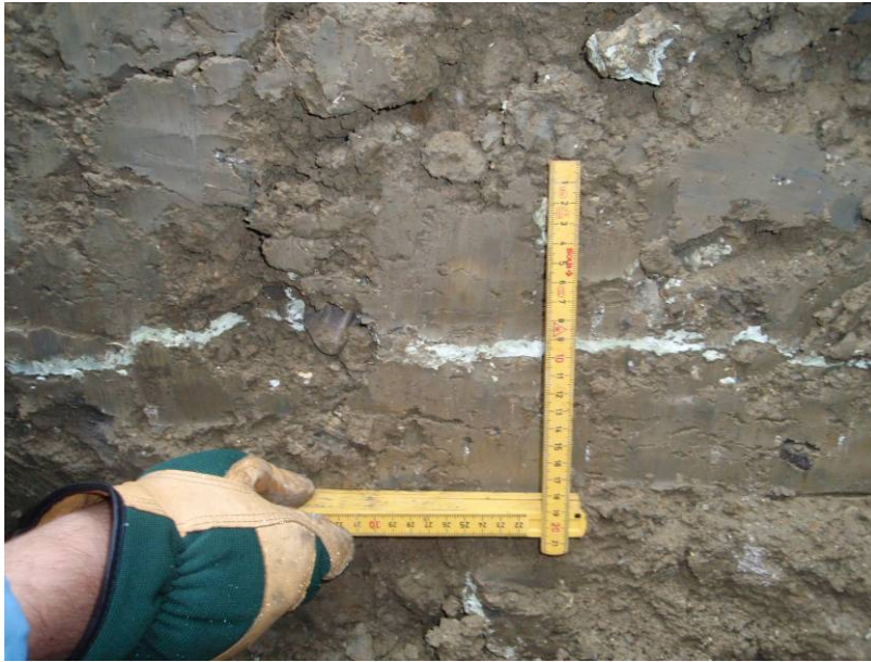
Figura 12, expansión del material de inyección en el tegel
