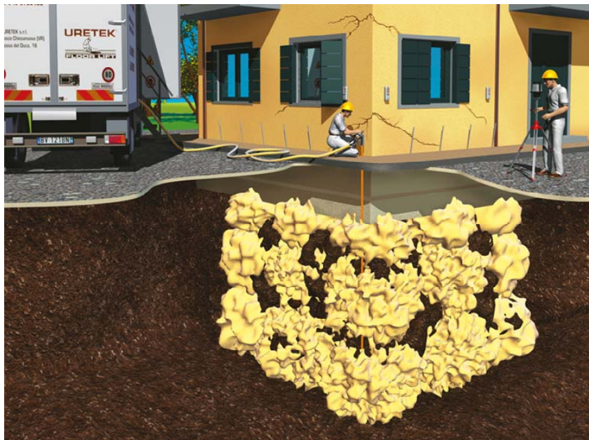
Figura 5. Intervención con la tecnología Uretek Deep Injections®
