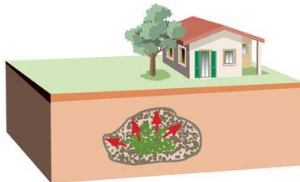
Fase 3. Expansión de la resina Geoplus® y precompresión de la bóveda de la caverna
