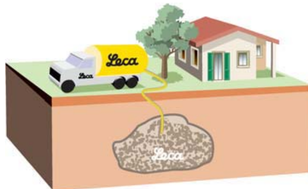
Fase 1. Relleno de la cavidad con arcilla expansiva Leca®
