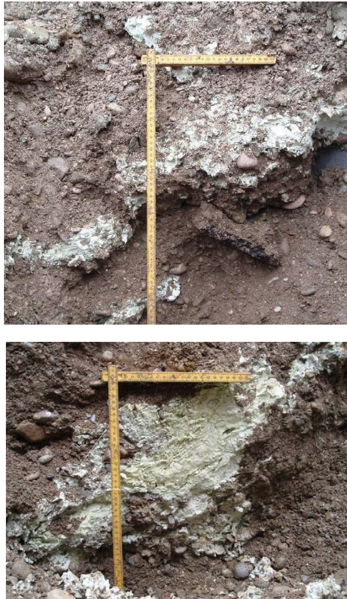
Figura 9. Mezcla “bulbo” de suelo granular (gravas y arenas)-resina.
