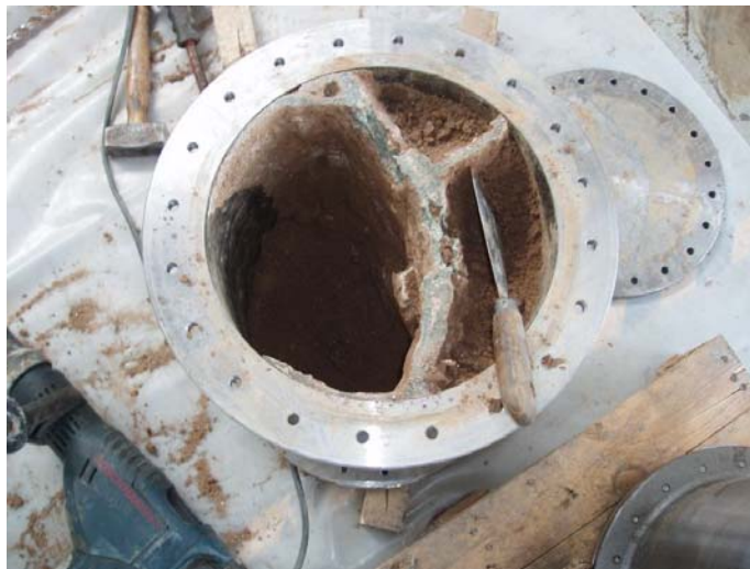
Figura 17. Base inferior del molde, donde se aprecia la resina solidificada dentro de las dos fracturas generadas en la arcilla compactada.
