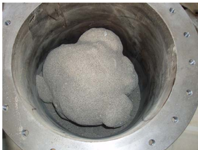
Figura 11. Base inferior del molde, donde se aprecia el “bulbo” de arena- resina.
