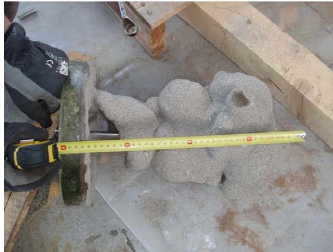
Figura 12. Dimensiones del “bulbo” de arena- resina y el tapón de resina.
