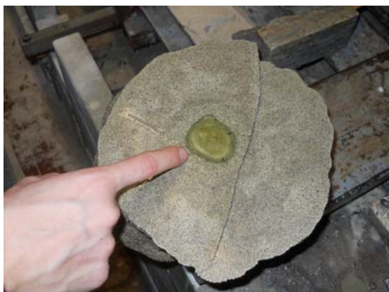
Figura 15. a) Sección transversal del bulbo, en el punto de inyección, b) Sección transversal del bulbo en el tramo final de la inyección.
