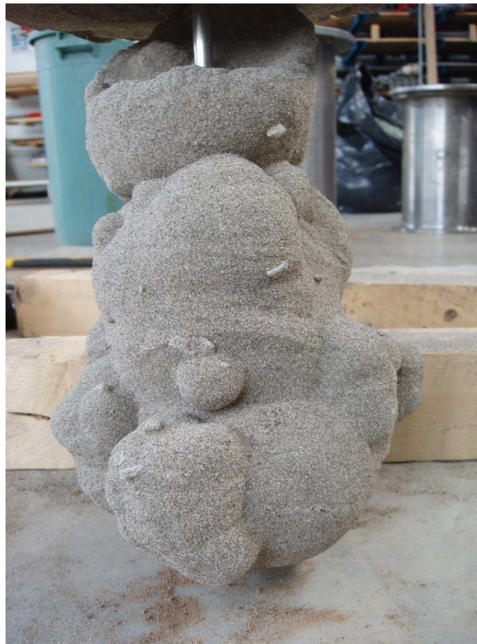
Figura 13. Bulbo de arena-resina extraído del molde.
