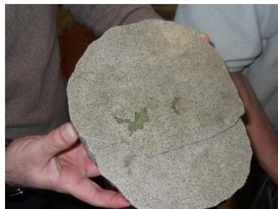
Figura 15. a) Sección transversal del bulbo, en el punto de inyección, b) Sección transversal del bulbo en el tramo final de la inyección.
