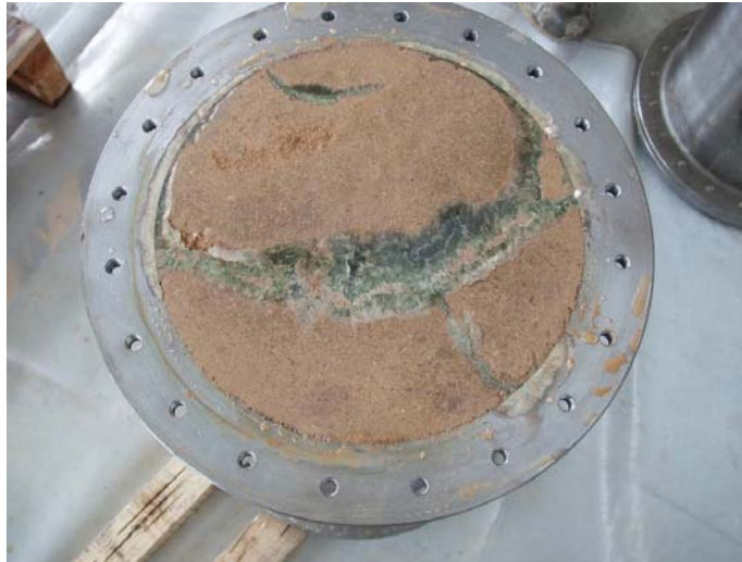
Figura 16. Base inferior del molde, donde se aprecia las dos fracturas rellenas de resina en la arcilla compactada.
