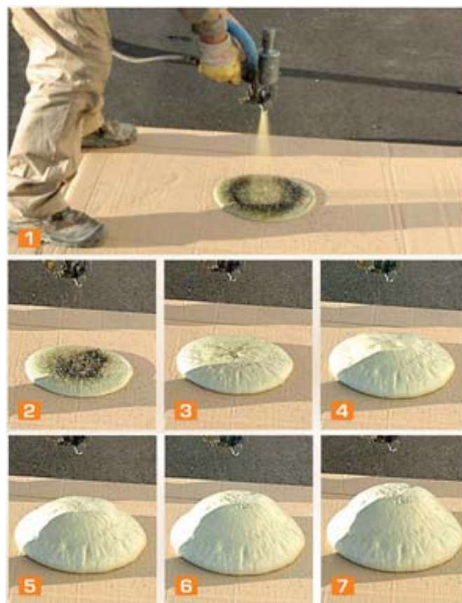
Figura 63. Fases de expansión de la Resina Geoplus® Uretek.
