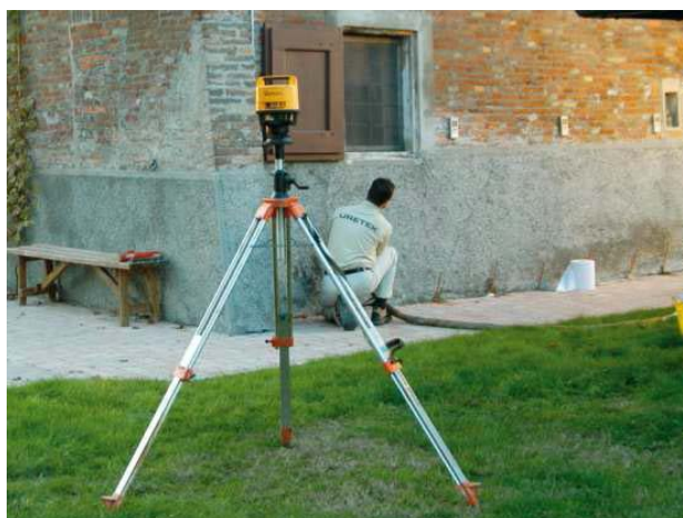
Figura 23. Nivel láser y dianas fijas en la estructura.
