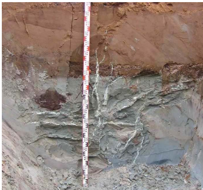
Figura 10. Rotura “claquage” de suelo cohesivo (arcillas)-resina
