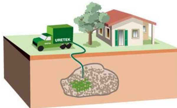
Fase 2. Inyección de resina de poliuretano expandente Geoplus®
