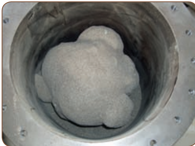
■ Figura 4.4. Aglomerado bulbiforme de resina dentro de la arena, vista desde el fondo del troquel.
