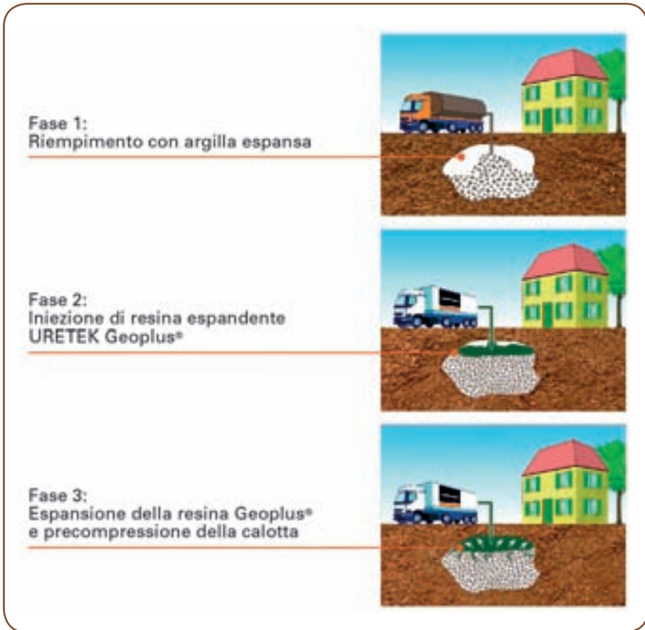
■ Figura 2.3. Principales fases de la tecnología Uretek Cavity Filling® (de www.uretek.it ).
