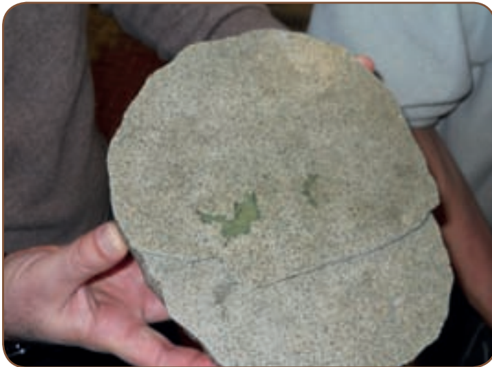
■ Figura 4.9. Sección transversal del añadido bulbiforme, efectuada bajo el punto de inyección. La resina ha penetrado totalmente entre los granos de arena.
