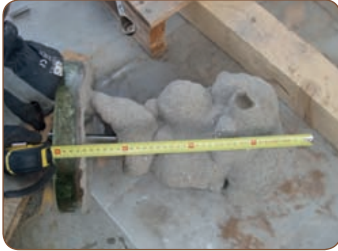
■ Figura 4.5. Dimensiones efectivas del aglomerado bulbiforme de resina obtenido por la inyección en la muestra de arena. También en este caso se ha comprobado la formación de un tapón de resina en contacto con la cubierta superior, donde se había dejado un espacio de 3-4 cm. aproximadamente
