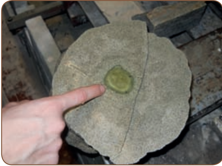
■ Figura 4.8. Sección transversal del añadido bulbiforme, efectuada en proximidad al punto de inyección. La resina ha penetrado entre los granos de arena a partir de la zona de inyección reconocible al estar ocupada por la resina pura. En el entorno del punto de inyección la resina, a consecuencia del proceso de penetración o permeación entre los granos, ha formado un aglomerado con los granos de arena.
