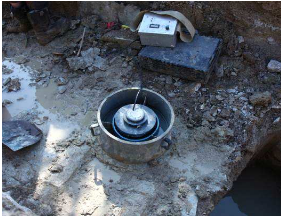
Foto 2[a]. Infiltrómetro anillo doble abierto-formación n°1 (1,2 m de profundidad)
