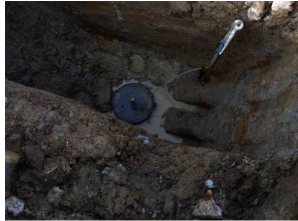
Foto 2[b]. Infiltrómetro anillo doble abierto-formación n°2 (2,1 m de profundidad)
