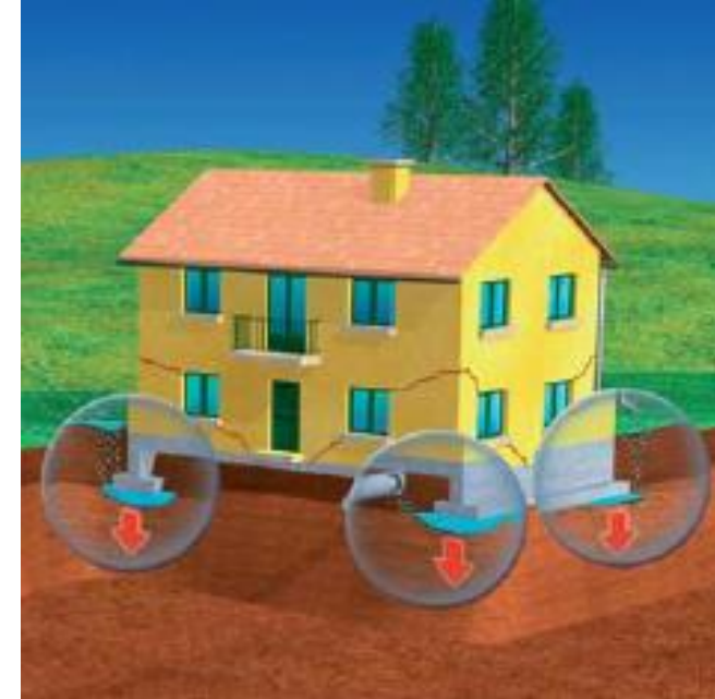
FUGAS DE AGUA
