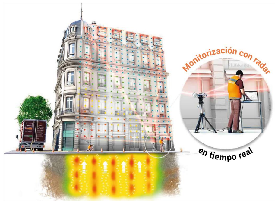
Monitorización con RADAR
