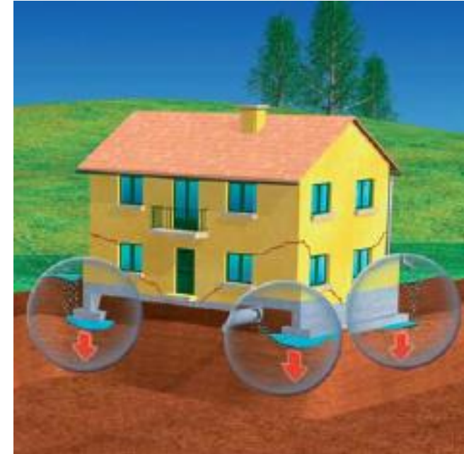
FUGAS DE AGUA
