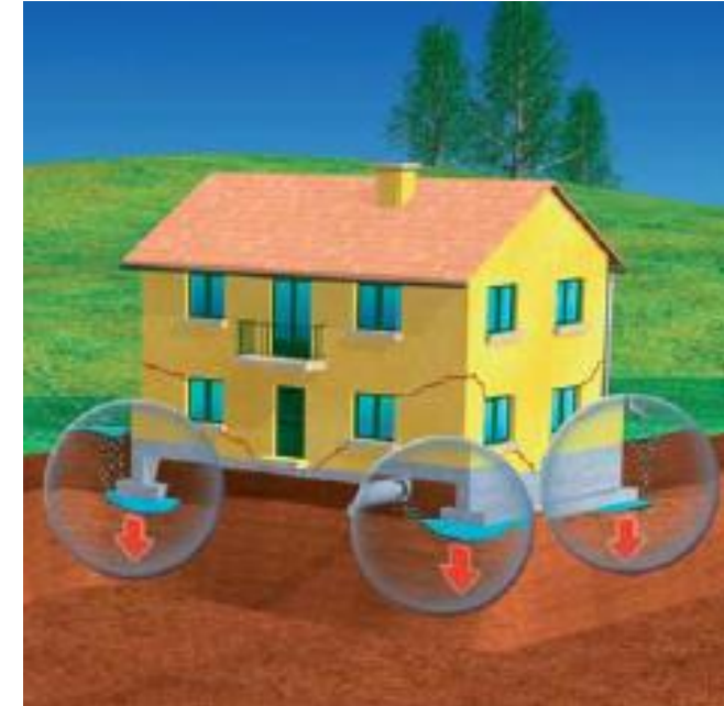
FUGAS DE AGUA
