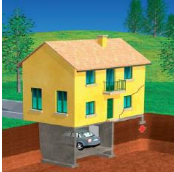
CIMENTACIÓN EN DOS NIVELES
