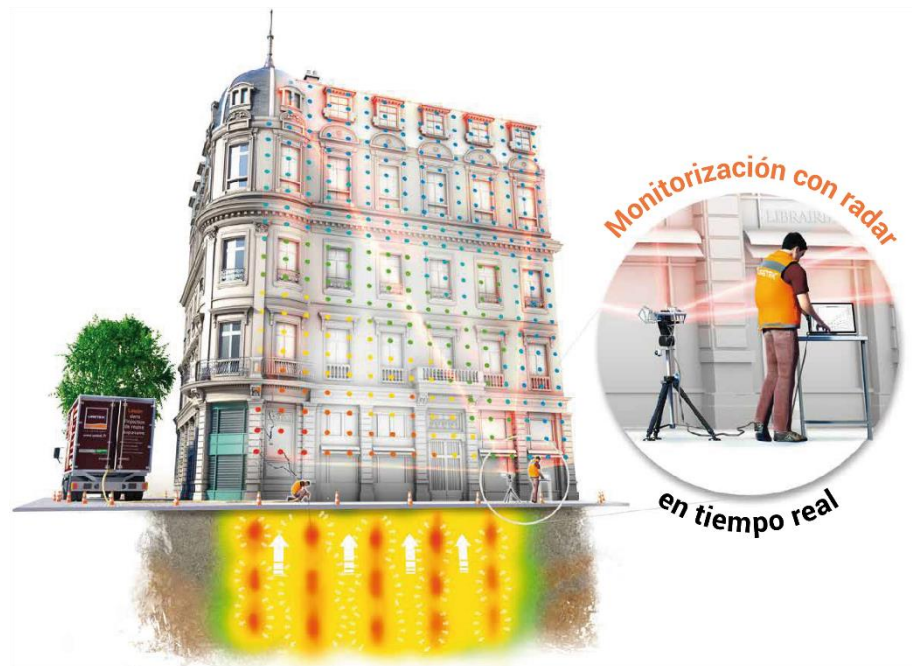
Monitorización con RADAR
