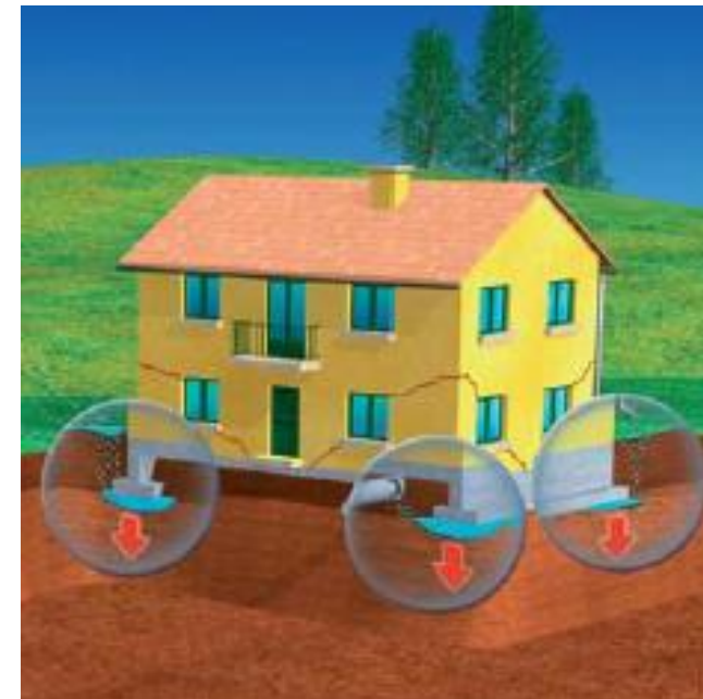
FUGAS DE AGUA
