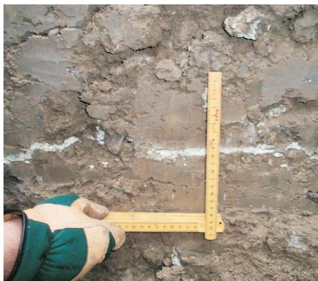
Gli effetti della penetrazione della resina nel terreno sono diversi: riempimento delle fessure di ritiro, idrofratturazione e compattazione
