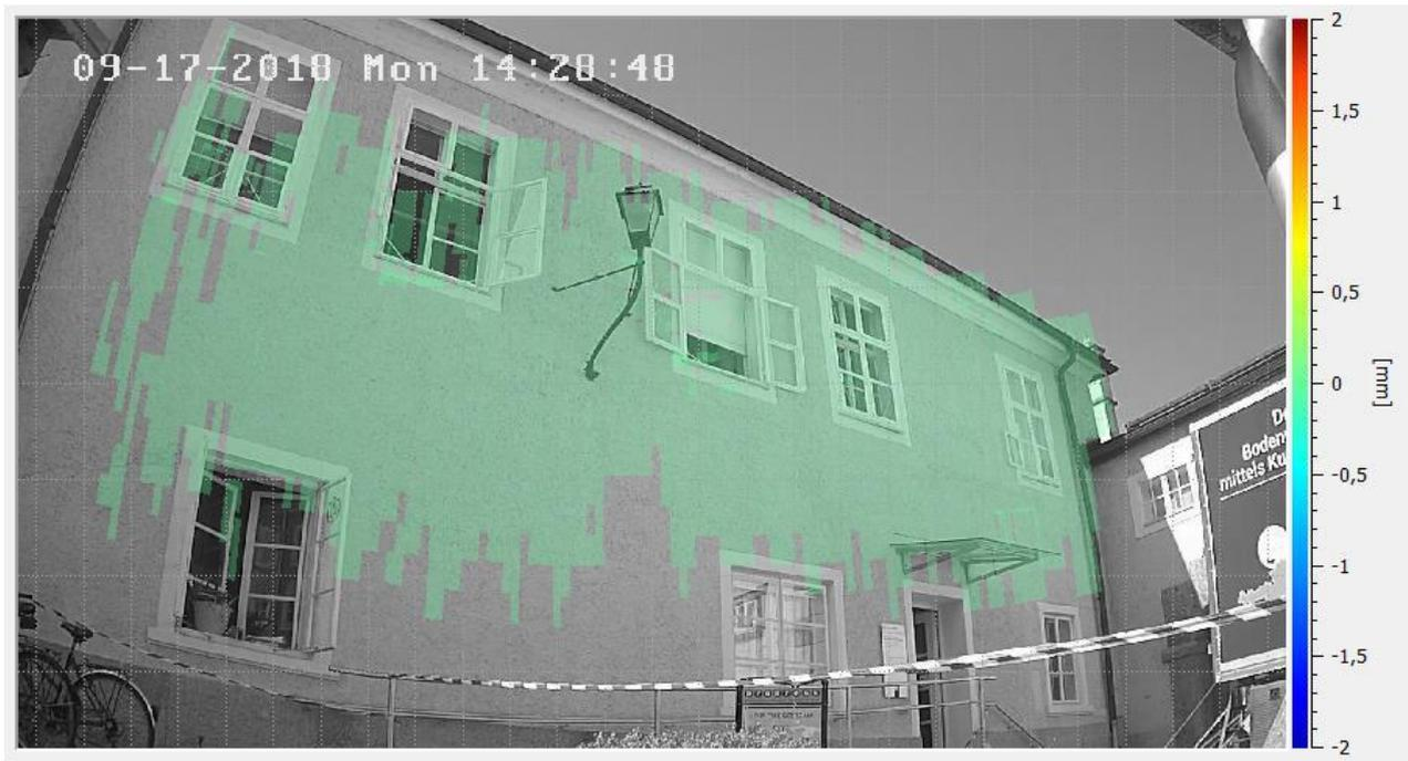
Abbildung 2-14: Vom Radar erfasste Punktwolke
