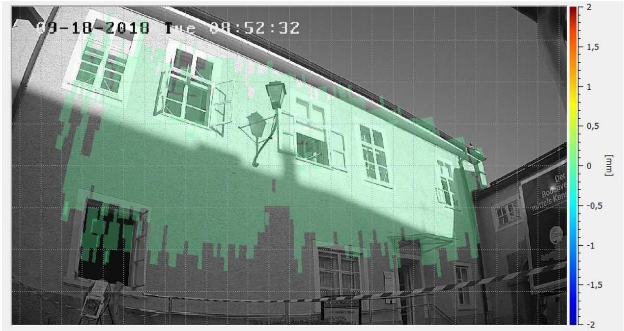
Abbildung 2-19: Vom Radar erfasste Punktwolke
