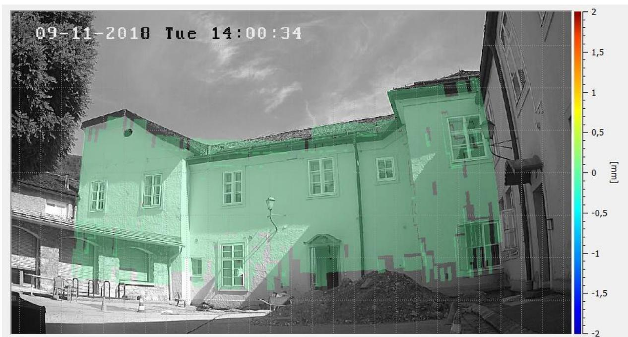
Abbildung 2-8: Vom Radar erfasste Punktwolke
