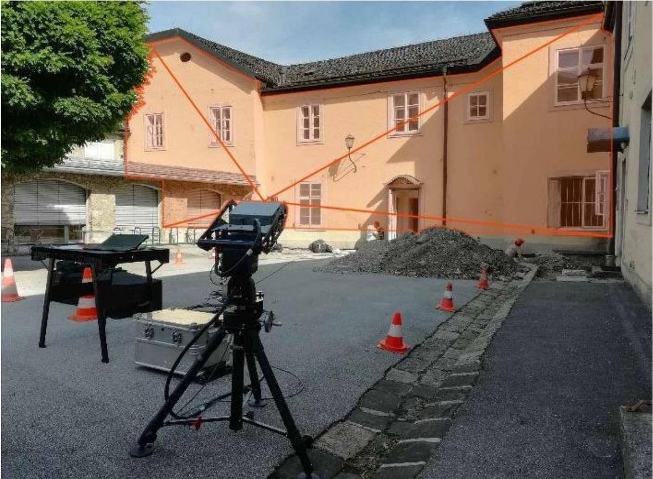
Abbildung 2-1: Positionierung des Radars (Rückansicht) mit Angabe des überwachten Bereichs
