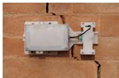
Figure 15. Easy Crack Monitor System<sup>®</sup>
