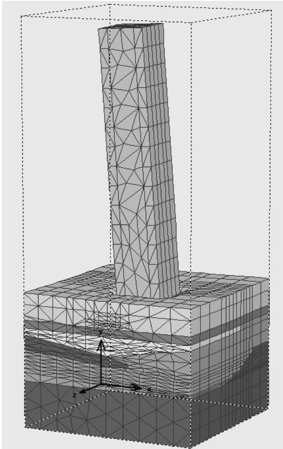
Figure 5. Città di Castello tower mesh for the FEM analysis
