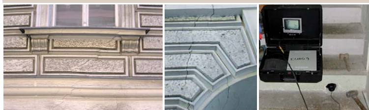
PROVE PENETROMETRICHE COMPARATIVE (penetrometro dinamico DPM 30) Test eseguiti sotto la fondazione nella zona di maggior cedimento
